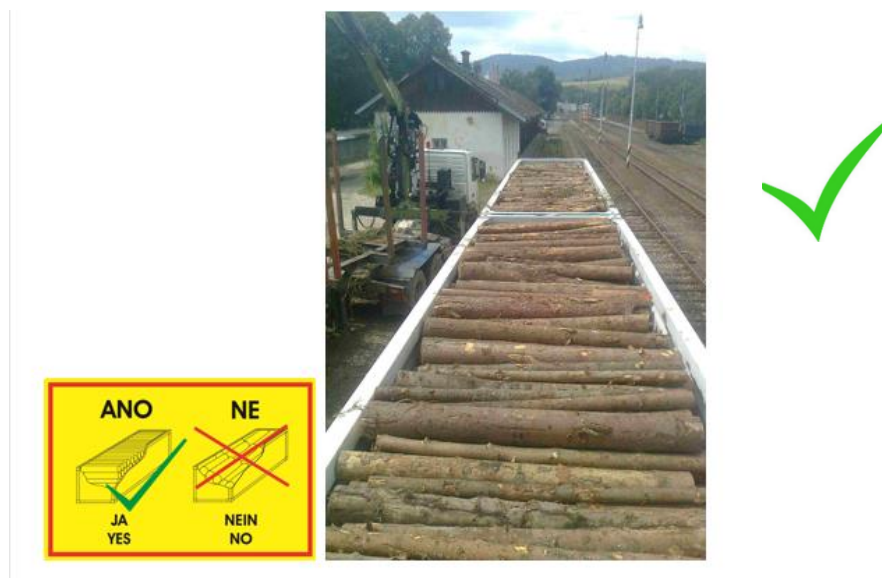
Obrázek 1: Ložení kulatiny 2m do vozů s kontejnerovou nástavbou (AgroTainer)
